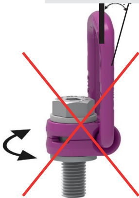
Kuva 3: kielletty kääntö kuormitettuna akselin suuntaan.
